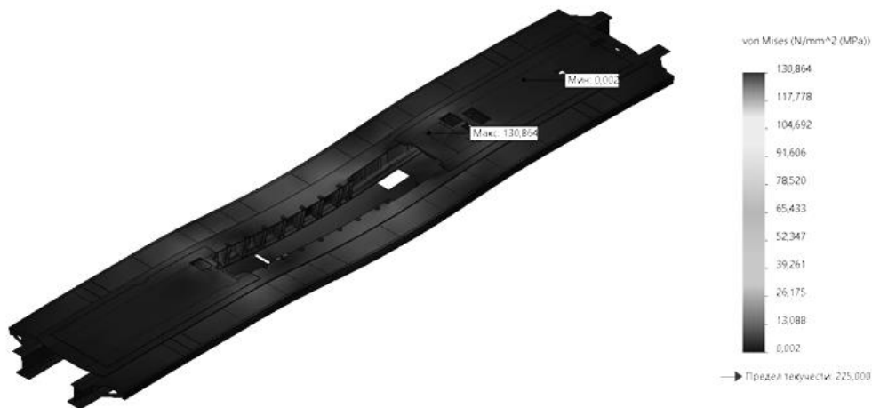
Рисунок 2. Анализ напряжения на главную раму тепловоза серии ТЭМ2
